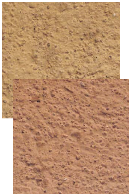
Gjennomfarget brettskurt overflate.
