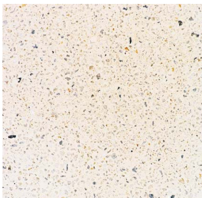
Hvit sement fremhever tilslagets lyse farge.
