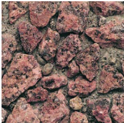
Frilagt rød Drammens granitt singel i rød fargepigmentert betong.
