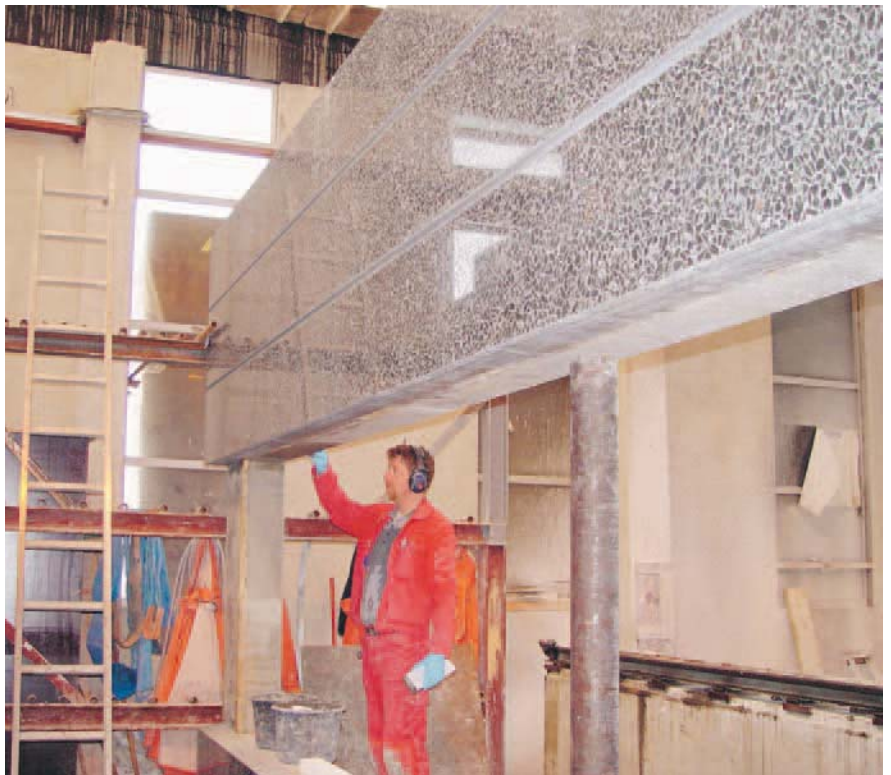
Etter at yttervangen er støpt legges isolasjonsmateriale og innstøpingsgodt i formen, deretter støpes innervangen.
