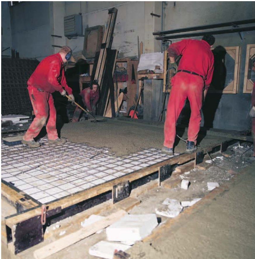
Etter at yttervangen er støpt legges isolasjonsmateriale og innstøpingsgodt i formen, deretter støpes innervangen.
