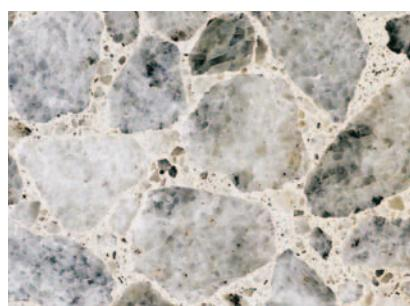
*Sliping av fasadeelementer varierer fra lett fjerning av sementslam i overflaten til dyp fresing og sliping.*
