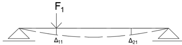
Figur 28: Gradvis belastning av kraft i punkt 1
