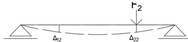
Figur 29: Gradvis belastning av kraft i punkt 2
